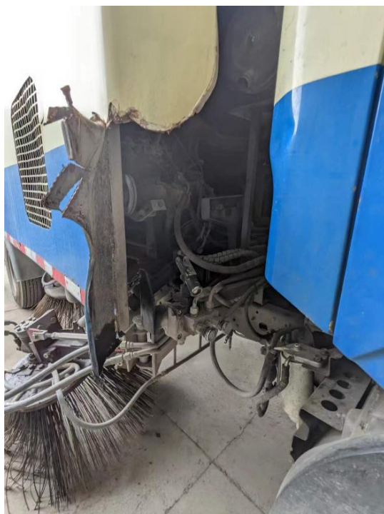
图 3 箱体前表面右下方的裁剪破洞
